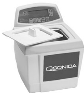
Ванна очиститель ультразвуковая лабораторная— C50T (1,9 л)
