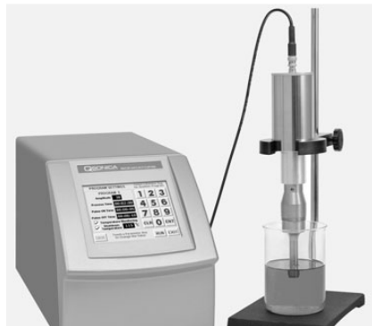
Гомогенизатор Q500 на 500 Вт ультразвуковой с зондом 1/2" 332 212.80 Р
