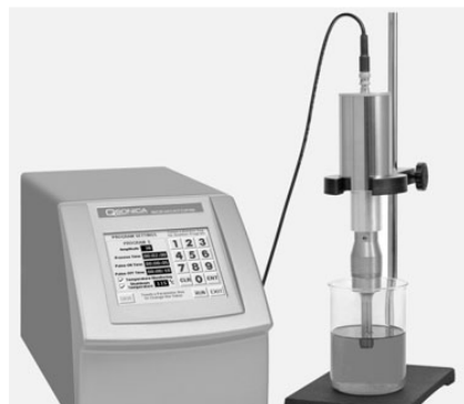
Гомогенизатор лабораторный ультразвуковой Q55 (55 Вт) с зондом 1/8"
