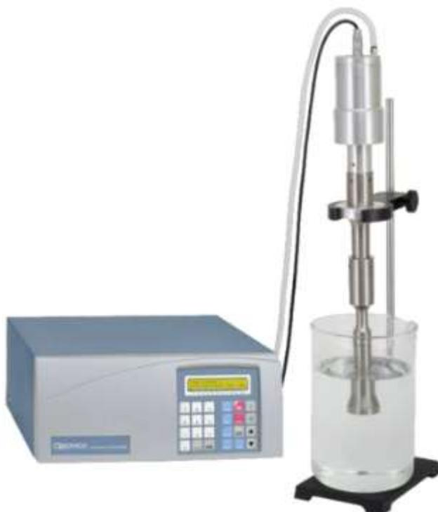
Q2000 предлагает возможность обработки больших объемов отдельными партиями или потоками через приложения. Эта модель включает в себя высокоамплитудный (100 мкм) зонд диаметром 1,5 дюйма с бустером и рекомендуется для проб объемом примерно 5–20 л. Стандартные применения включают эмульгирование, лизис клеток, дегазацию, гомогенизацию, солубилизацию, деагломерацию и диспергирование.
