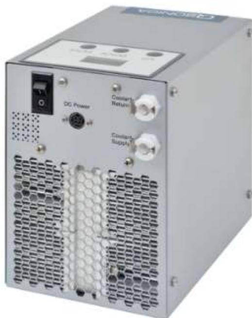
Обработка ультразвуком выделяет тепло, которое может быть вредным для некоторых приложений. Этот чиллер высокой производительности легко автоматизирует процесс охлаждения. Он сохраняет образцы прохладными, занимая при этом очень мало места на столе. Больше нет необходимости контролировать температуру, добавляя кусочки льда и постоянно меняя воду.
